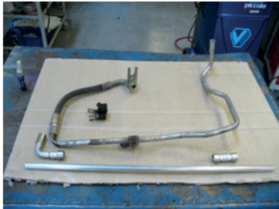
Vanha putki ja tarvittavat Lokring-korjausosat.
